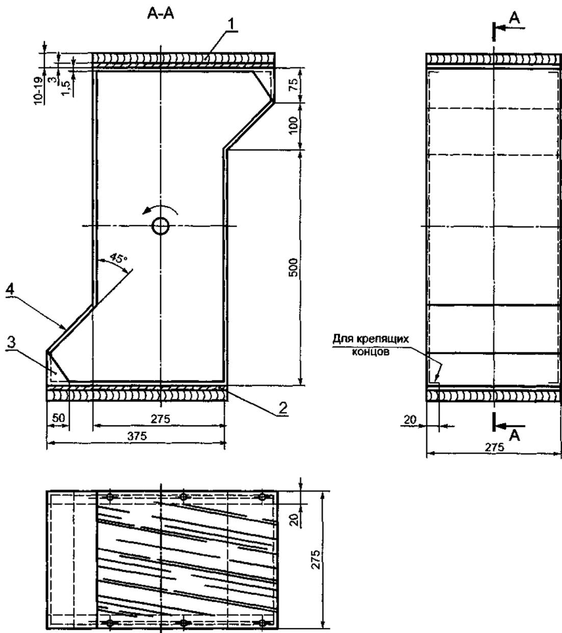
1 — деревянный брус; 2 — стальная плита; 3 — резиновый уголок; 4 — лист, ламинированный пластиком
