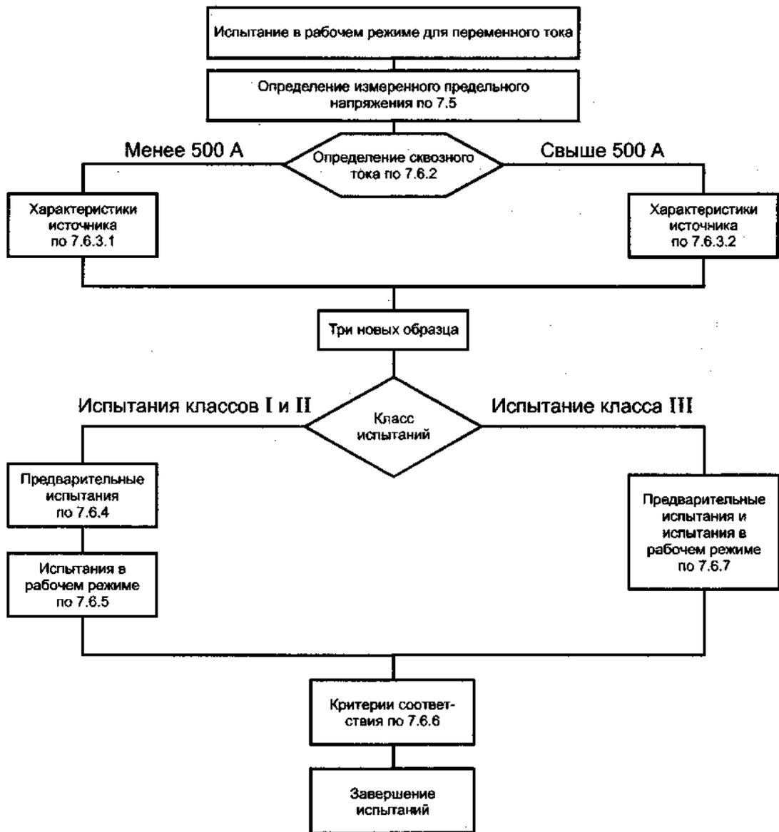
Рисунок 5 — Схема испытания в рабочем режиме
