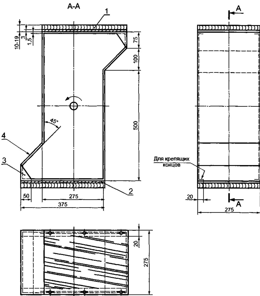
1 — деревянный бруск; 2 — стальная плита; 3 — резиновый уголок; 4 — лист, ламинированный пластиком
