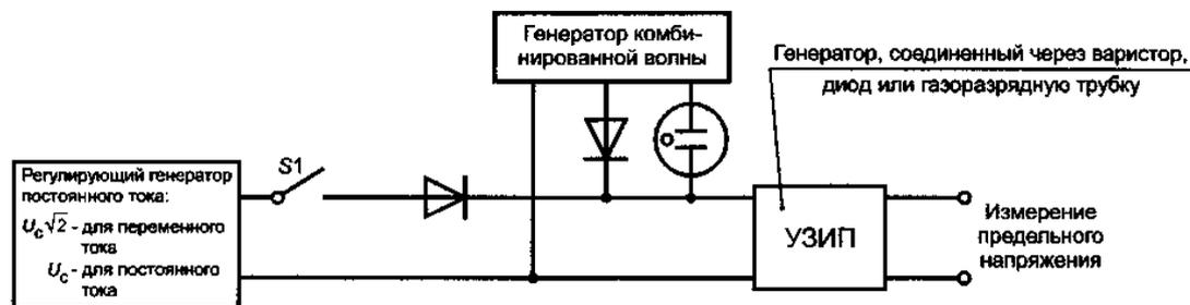
Рисунок 4 — Альтернативное испытание на измеренное предельное напряжение
