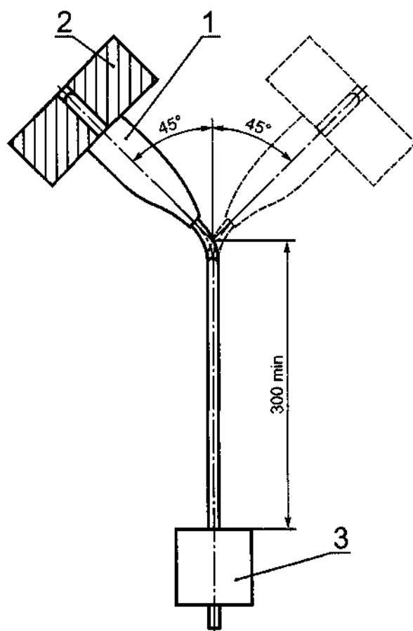
1 — образец; 2 — устройство для крепления образца; 3 — груз
