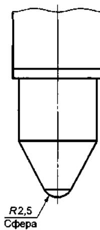
Рисунок 12б — Нагрузочный стержень для испытания давлением шарика
