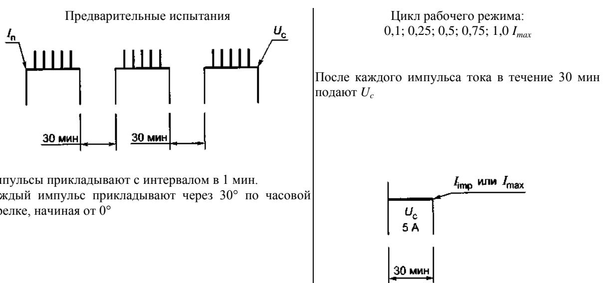
Рисунок 6 — График предварительного испытания и испытания в рабочем режиме
