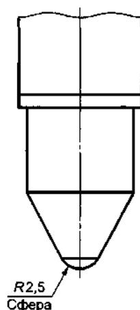
Рисунок 12б — Нагрузочный стержень для испытания давлением шарика
