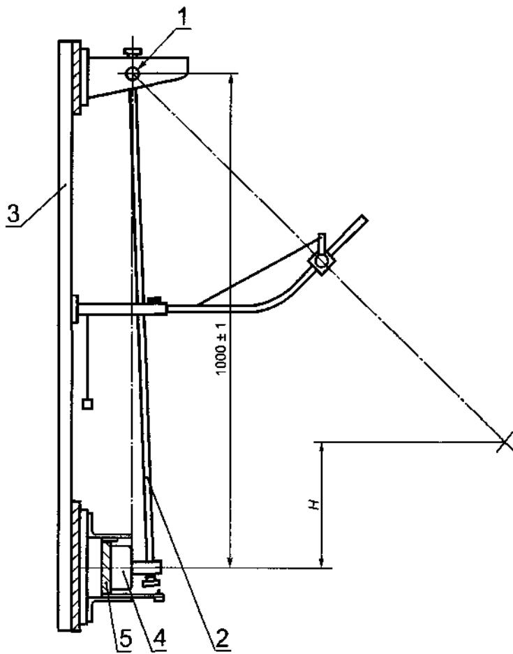
1 — шарнир; 2 — стальная трубка; 3 — рама; 4 — образец; 5 — монтажный крепеж;
