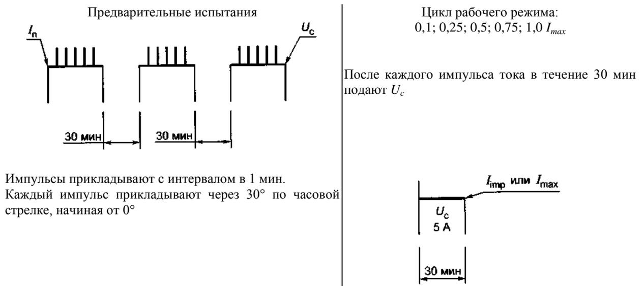
Рисунок 6 — График предварительного испытания и испытания в рабочем режиме
