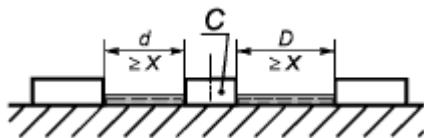
Воздушный зазор равен  $d + D$ .
