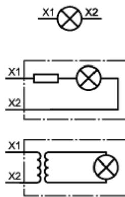
Примечание - Термин "Система сигнальных ламп" включает в себя также понятия встроенный резистор или трансформатор.
