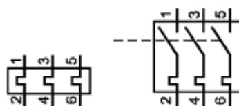
В аппаратах с защитой от перегрузок выводы вспомогательного контакта имеют ту же маркировку, что и контакт специального назначения (см. L.3.2.1.2), но с порядковым номером 9.
