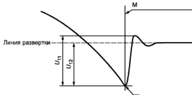
Рисунок Е.1 - Определение фактического значения коэффициента  $\gamma$
