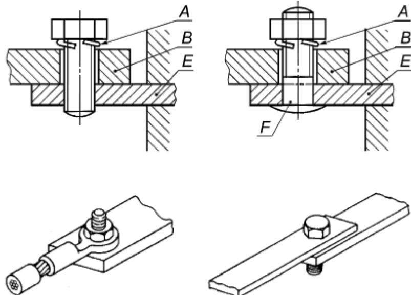
*A* - запорное устройство; *B* - кабельный наконечник или шина; *E* - неподвижная часть; *F* - штифт
