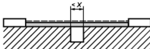
Условие: рассматриваемый путь утечки охватывает желобок с параллельными или сходящимися боковыми стенками любой глубины при ширине менее  $X$  мм.
