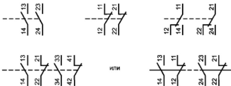
L.3.2.2.2 Порядковые номера могут не проставляться на выводах только в случае, если имеется дополнительная информация, предоставленная изготовителем или потребителем, позволяющая четко определить порядковый номер.
