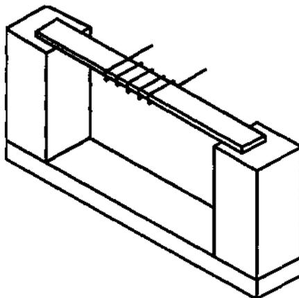
Рисунок М.1 — Приспособление для испытания нагретой проволокой
