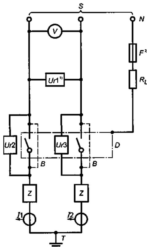
$S$  — источник питания;  $Ur1$ ,  $Ur2$ ,  $Ur3$  — датчики напряжения;  $V$  — вольтметр;  $N$  — нейтраль (искусственная);  $F$  — плавкий элемент (8.3.3.5.2g);  $Z$  — цепь нагрузки (см. рисунок 8);  $R_L$  — токоограничивающее сопротивление;  $D$  — испытуемый аппарат (с присоединенными проводниками).
