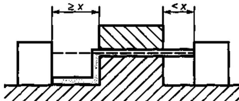
Условие: рассматриваемый путь охватывает нескрепленный стык с желобком шириной менее  $X$  мм с одной стороны или более с другой стороны.
