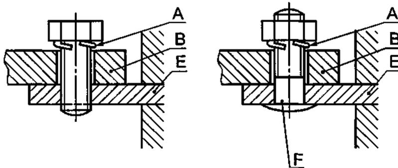
*A* — запорное устройство; *B* — кабельный наконечник или шина; *E* — неподвижная часть;
