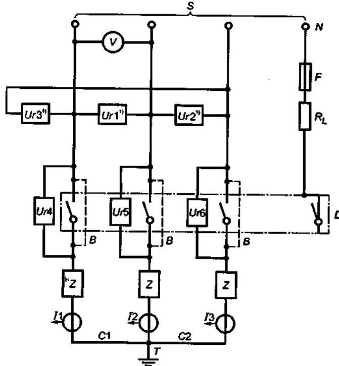
$S$  — источник, питания;  $Ur1, Ur2, Ur3, Ur4, Ur5, Ur6$  — датчики напряжения;  $V$  — вольтметр;  $N$  — нейтраль (искусственная нейтраль);  $F$  — плавкий элемент (8.3.3.5.2g);  $B$  — переключки для настройки контура;  $Z$  — цепь нагрузки (см. рисунок 8);  $R_L$  — токоограничивающее сопротивление;  $D$  — испытуемый аппарат (с присоединенными проводниками).
