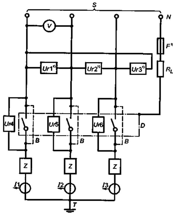
$S$  — источник питания;  $Ur1, Ur2, Ur3, Ur4, Ur5, Ur6$  — датчики напряжения;  $V$  — вольтметр;  $N$  — нейтраль (искусственная);  $B$  — переключки для настройки контура;  $F$  — плавкий элемент (8.3.3.5.2g);  $Z$  — цепь нагрузки (см. рисунок 8);  $R_L$  — токоограничивающее сопротивление;  $D$  — испытуемый аппарат (с присоединенными проводниками).
