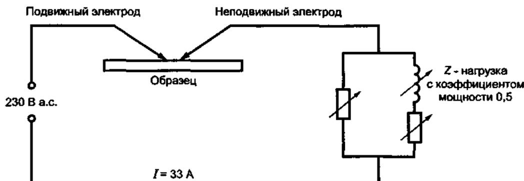
Рисунок М.2 — Схема для испытания на воспламеняемость электрической дугой
