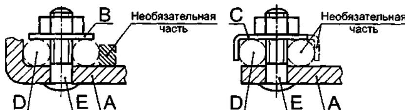
*A* — неподвижная часть; *B* — шайба для прокладки; *C* — устройство, препятствующее выскальзыванию проводника; *D* — место для проводника; *E* — штифт
