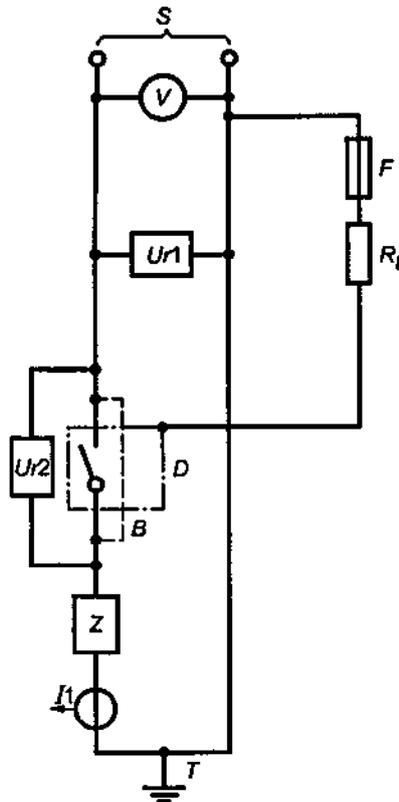
$S$  — источники питания;  $Ur1$ ,  $Ur2$  — датчики напряжения;  $F$  — плавкий элемент (8.3.3.5.2g);
