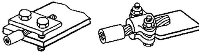
Выводы с прокладками — резьбовой вывод, в котором проводник зажимается под прокладкой с помощью двух или нескольких винтов или гаек.
