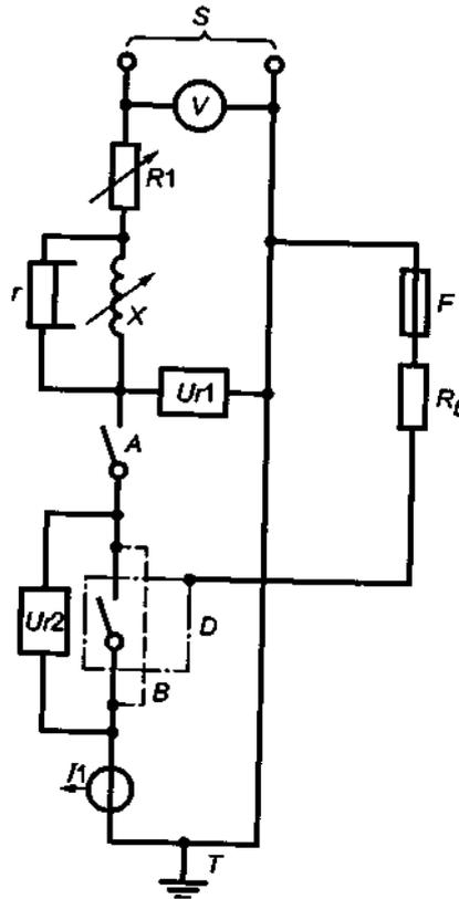
$S$  — источник питания;  $Ur1$ ,  $Ur2$  — датчики напряжения;  $V$  — вольтметр;  $A$  — замыкающее устройство;  $R1$  — регулируемое активное сопротивление;  $F$  — предохранитель (см. 8.3.4.1.2d);
