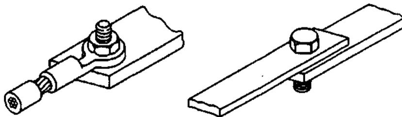
Резьбовый или штифтовый вывод предназначен для зажима кабельного наконечника или шины с помощью винта или гайки
