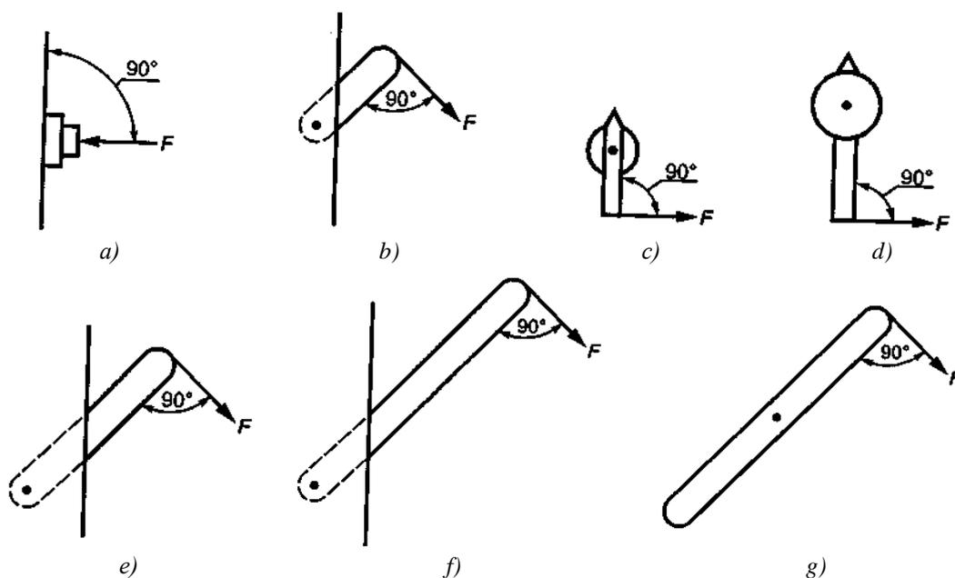
Рисунок 16 — Испытательное усилие, прикладываемое к органу управления (см. 8.2.5.2.1 и таблицу 17)
