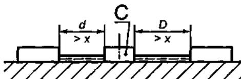
Воздушный зазор равен  $d + D$ .
