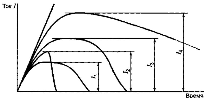
$I_1$  — первая калибровка;  $I_2$  — действительный ток отключения;  $I_3$  — вторая калибровка;
