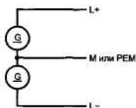
Рисунок 7 - Трехпроводная система
