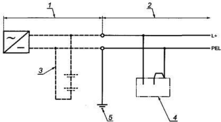
Примечание 1 — В электроустановке допускается дополнительное заземление PEL-проводника.
