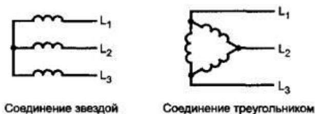
Рисунок 4 - Трехфазные трехпроводные системы
