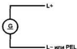
Рисунок 6 - Двухпроводная система
