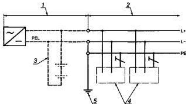
Примечание 1 — В электроустановке допускается дополнительное заземление защитного проводника (PE).
